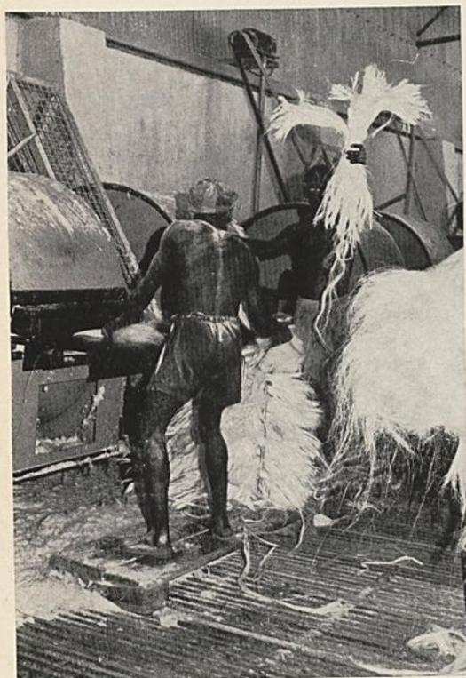
Faserbürstmaschinen veredeln die getrockneten Sisalfasern und bedecken die schwarzen Körper der Arbeiter mit weißem Staub.
