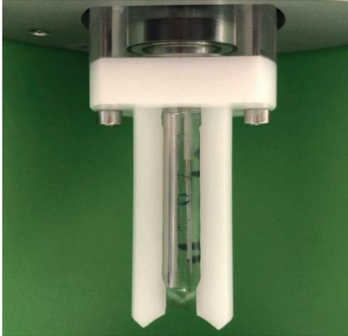
Abb. 2: „CyFlow Ploidy Analyzer“ der Firma Partec; Elektrode. – CyFlow Ploidy Analyzer“ by Partec; electrode.
