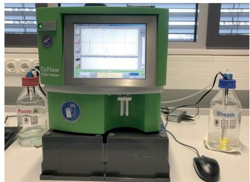
Abb. 1: „CyFlow Ploidy Analyzer“ der Firma Partec; Baujahr 2009, Gewicht 11,5 kg, Breite: 32,5 cm, Höhe: 33 cm, Tiefe: 26,5 cm. – CyFlow Ploidy Analyzer“ by Partec; year of manufacture 2009, weight 11.5 kg, width: 32.5 cm, height: 33 cm, depth: 26.5 cm.
